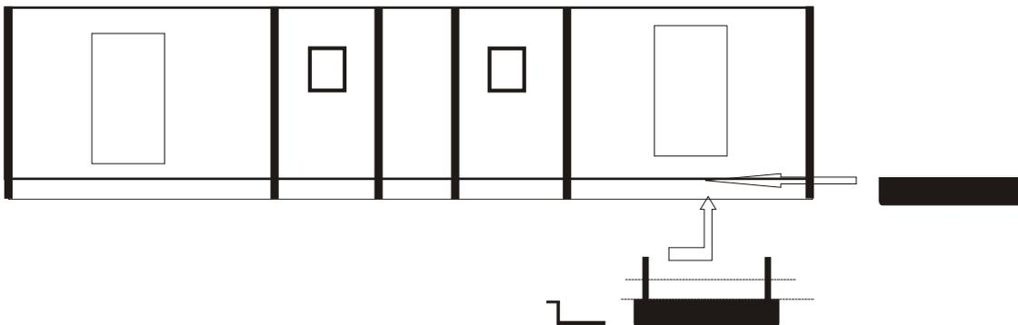
12-assembler le chassis à la caisse, mettre les tampons .
